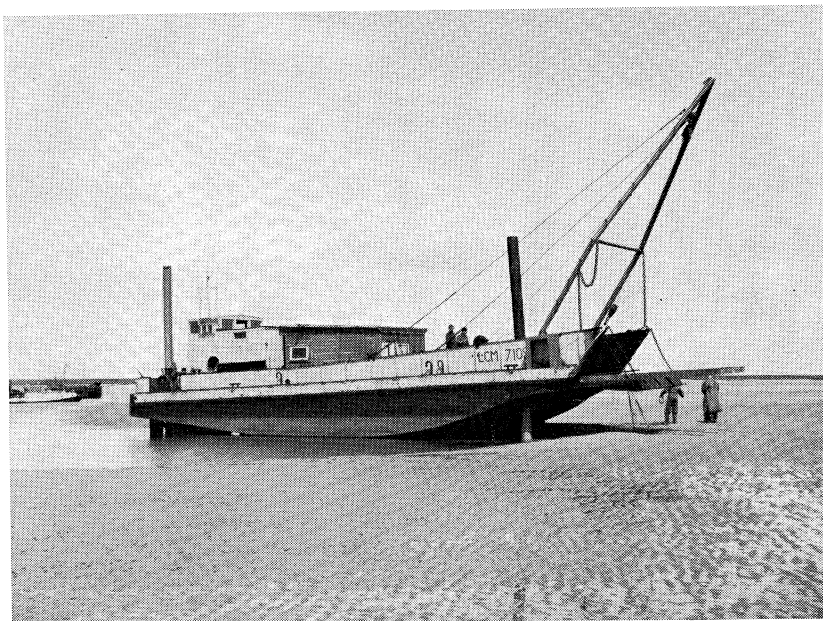
Landingsvaartuig ingericht voor het boren
